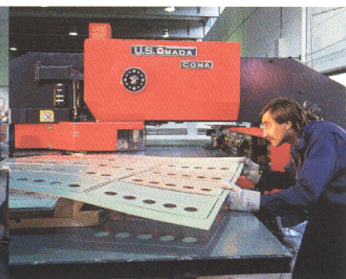
CNC styrt stanseautomat 50 t med 66 verktøy
